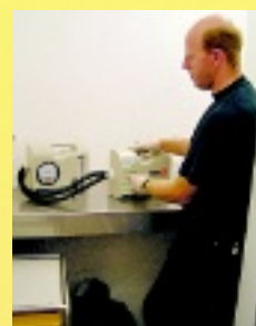
Die VDE- und Funktionsprüfung der Kompressoren schließt sich an.
