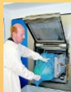
Die Entnahme des gereinigten Wechseldrucksystems erfolgt an der reinen Seite.
